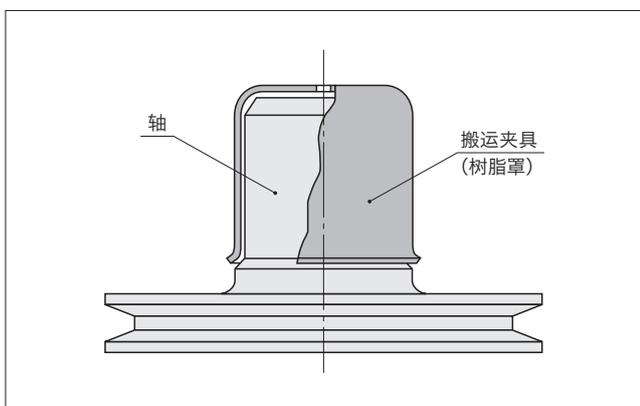
〈图-2.〉 为轴的搬运夹具，使用树脂制成的罩子来防止轴“损伤”。
